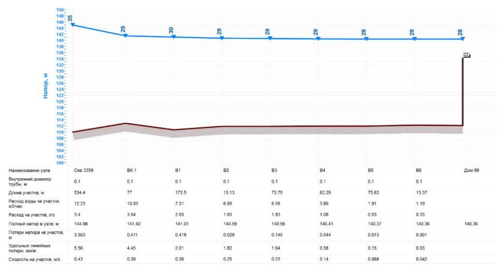
Пьезометрический график системы водоснабжения дер. Меньково
