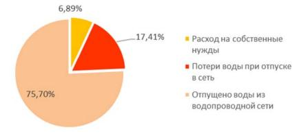
Рисунок 16 Общий баланс подачи и реализации воды в СП
