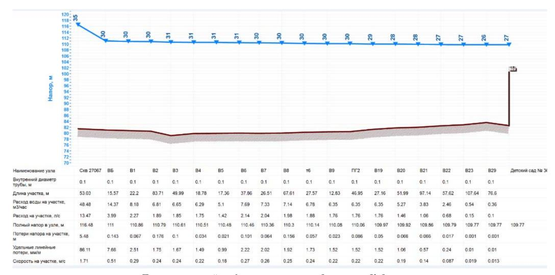
Пьезометрический график системы водоснабжения пос. Кобринское
