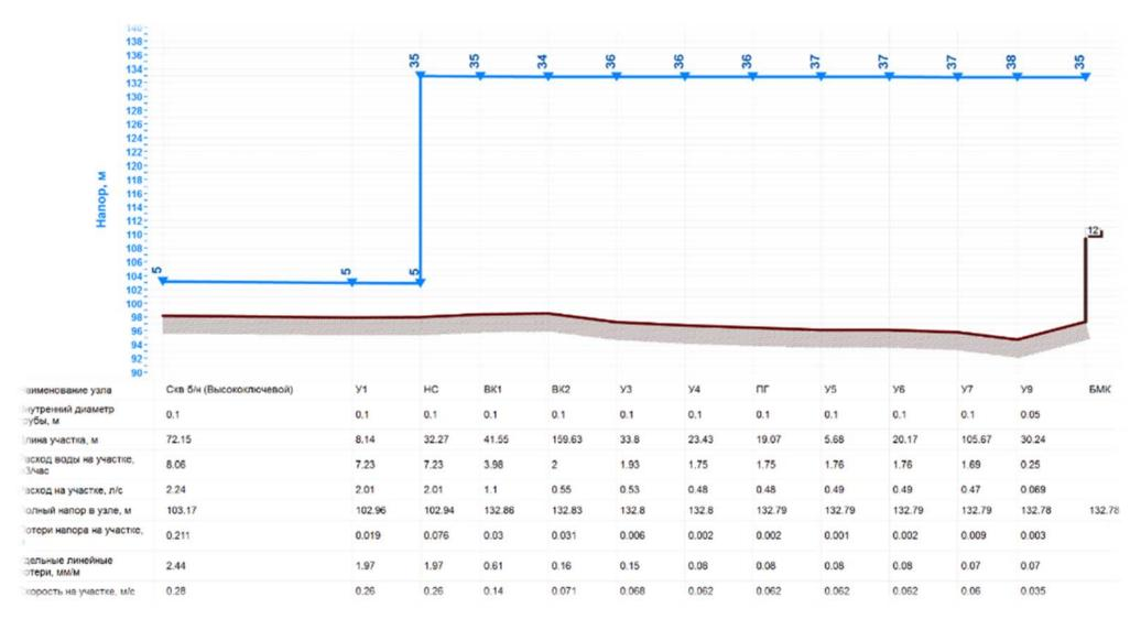
Пьезометрический график системы водоснабжения пос. Высокоключевой
